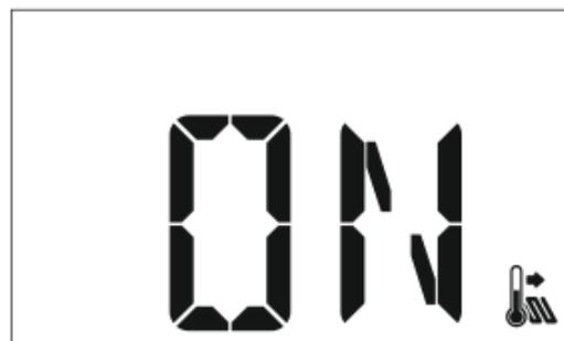
Для выключения теплого пола нужно нажать кнопку ПЛЮС. Выбор нужно подтвердить при помощи кнопки МЕНЮ (подтверждение и переход к редактированию очередного параметра) или кнопки EXIT (подтверждение и выход на главный экран).
