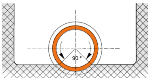
Рис. 5 Укладка в ненарушенный грунт естественного залегания (тип основы 2)
