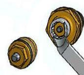
7.5. Притеч из-под штока регулировочного клапана, головка клапана может быть снята, отремонтирована или заменена. Головка отвинчивается с помощью гаечного ключа. Сливать воду из коллектора при этом не нужно.
