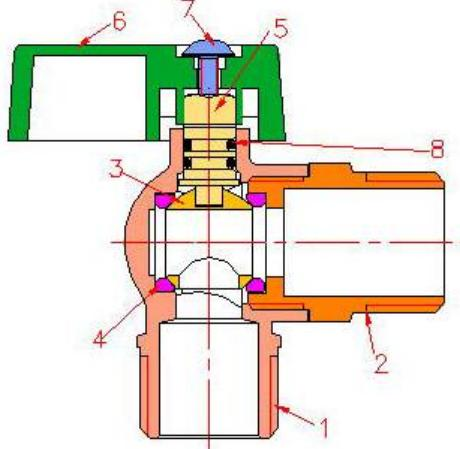
Корпус крана выполнен из двух латунных (CW617N) деталей (1,2), соединенных между собой на резьбе с проклейкой анаэробным клеем Loctite (допущен для контакта с пищевыми жидкостями). Запорный орган крана представляет из себя латунный (CW614N) шар (3) с хромовым гальванопокрытием, приводимый в движение латунным (CW614N) штоком (5). В качестве седельных уплотнений использованы тefлоновые (PTFE) кольца (4). Шток уплотнен двумя сальниковыми кольцами из EPDM (8). Нейлоновая никелированная
