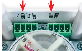
Фото 13. Клеммы подключения проводных датчиков – INP, GND
