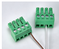
Фото 14. Подключение провода датчика к ответной части разъема
